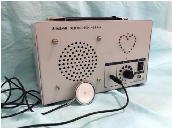
拡張心音計（心臓の音を拡大してスピーカーから聞くことができる機械）
